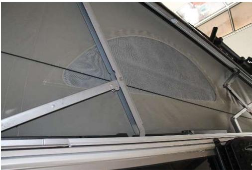
2. Gummiband zwischen Zeltbalg und Scherengelenk fädeln
