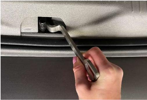
2. Heckklappenaufsteller in den Schließbügel am Fahrzeug einhängen
