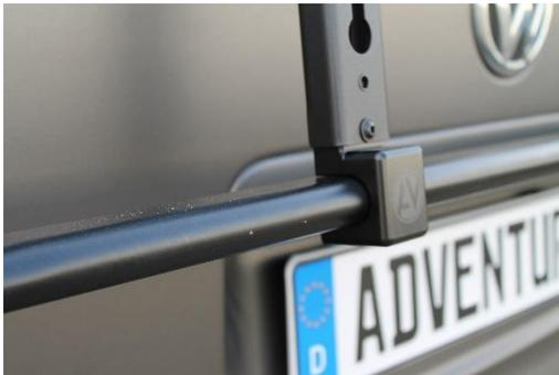
3. Back-Rack über das Rohr des Fahrradträgers stecken
