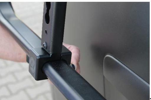
4. Klemmschalen von hinten leicht anschrauben
