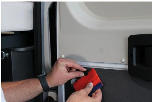
1. Alle Kunststoff-Clips entfernen (ggf. mit einem Kunststoffkeil oder entsprechendem Werkzeug)
