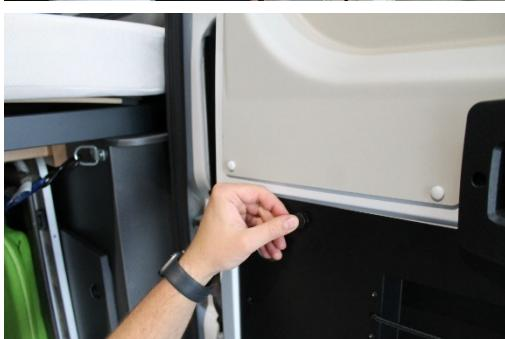
4. Heckorganizer einsetzen und mit den Kunststoffclips befestigen
