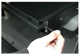
2. Die beiden seitlichen Schrauben der Einhandbedienung links und rechts leicht anschrauben
