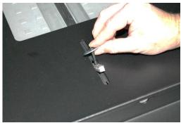
8. Nutensteine durch die Schlitze in die Sitzbankschiene einführen (darauf achten, dass die Nutensteine komplett in der Schiene sind)
