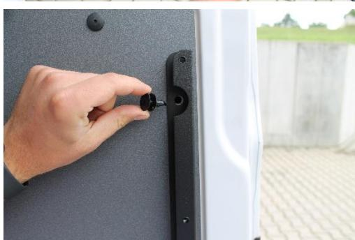
4. Halteleiste mit den originalen Kunststoffclips befestigen
