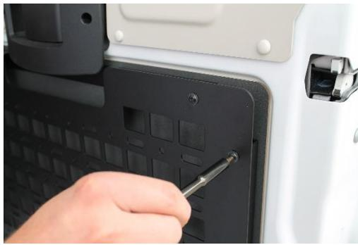
7. Molle-Board auf die Halteleisten aufsetzen und alle Schrauben leicht anschrauben
