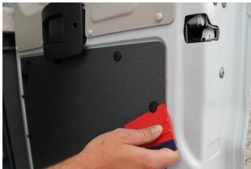
1. Der Reihe nach die Kunststoffclips entfernen
