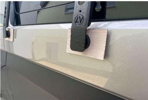
2. Zum einfacheren verschieben kann ggf. ein Stück Karton unter den Magnet gelegt werden
