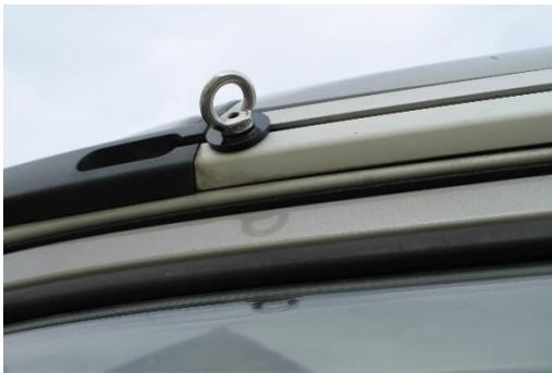
2. Nutenstein in die Multitrail-Schiene einschieben
