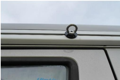
3. Ösenschraube auf die gewünschte Position verschieben und durch Drehen fixieren
