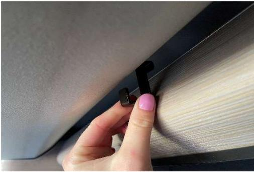
2. Haken vom Kofferraum aus in den geöffneten Dachschränk einhängen
