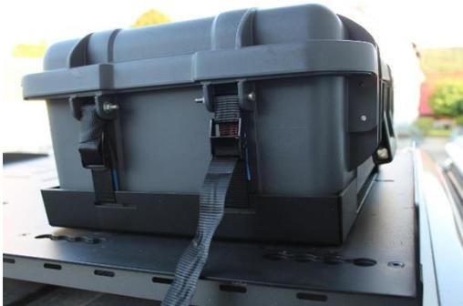
3. Koffer mit Spannguten befestigen
