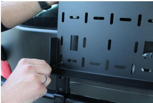
2. Halteplatte mit den Schrauben befestigen
