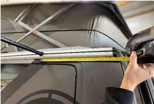
3. Nutensteine auf die gewünschte Position verschieben (ca. 40 cm vom Rand entfernt) und durch Drehen fixieren
