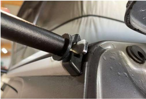
2. Nutensteine in die Multitrail-Schiene einschieben
