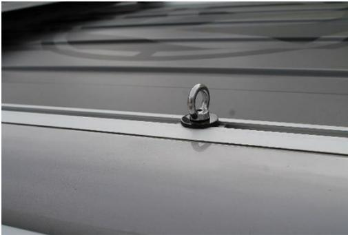
2. Nutenstein in die C-Schiene des Aufstelldachs einschieben
