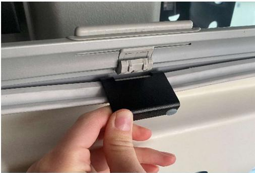
2. Kühlboxöffner mit der Seite der Aussparung unter den Gummi der Kühlbox klemmen
