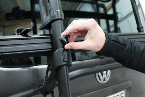
1. Sterngriffmuttern der Radschiene entfernen
