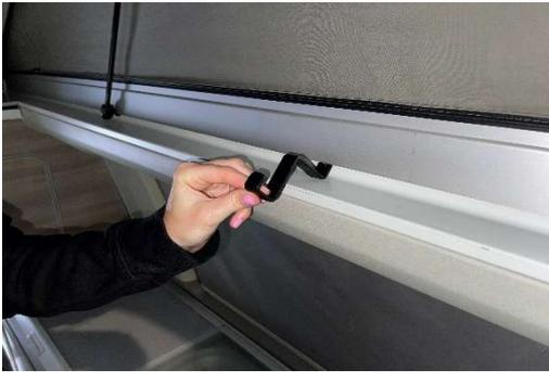
2. Haken in die Schiene des Aufstelldachs einhängen
